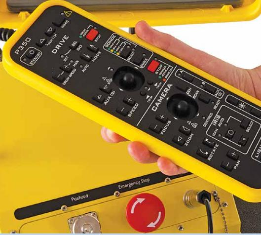
El control remoto proporciona controles convenientes para el fondo de perforaciones durante el despliegue y la recuperación.
