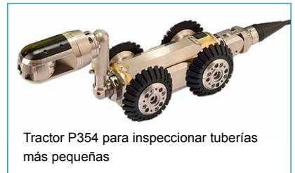
Tractor P354 para inspeccionar tuberías más pequeñas
