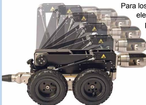
Para los trabajos en tuberías más grandes, los elevadores ajustables y ruedas más grandes proporcionan cobertura para una variedad de tamaños de tuberías, mientras que el elevador eléctrico permite el ajuste fino, a distancia, y asegura un centrado compatible en tuberías de 12"/305 mm a 36"/900 mm).
