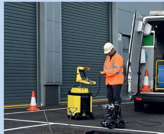
Sistema de creación de informes integrado y personalizable, crea y exporta informes detallados en formato XML de inspecciones de desagües o cámaras de inspección que cumplen con MSCC5.
