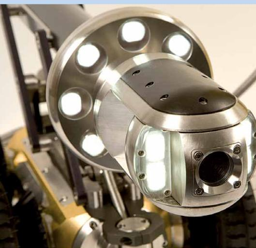
La luz frontal auxiliar proporciona iluminación adicional para tuberías grandes u oscuras.
