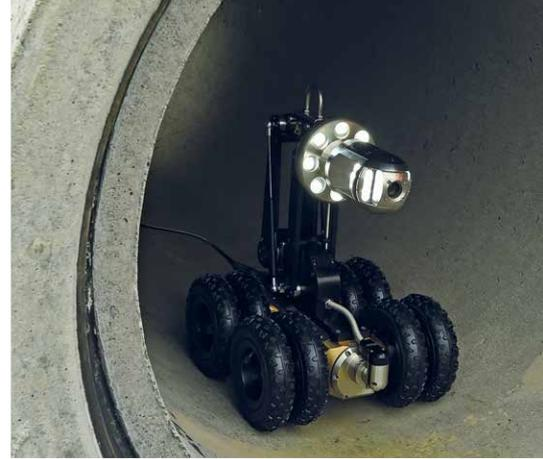
Un elevador eléctrico permite la inspección de tuberías de hasta 36"/900 mm de diámetro.
