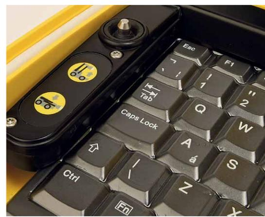
Los controles de joystick de la cámara y del tractor ofrecen un funcionamiento intuitivo, con controles comunes colocados al alcance de la mano.
