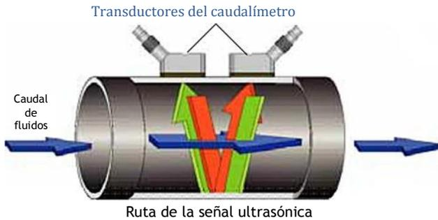
Con la medición de caudal por tiempo de tránsito, dos transductores funcionan como generadores y receptores de las señales ultrasónicas. Cuando se montan en una tubería, establecen una comunicación acústica entre sí, lo que significa que el segundo transductor puede recibir señales ultrasónicas transmitidas por el primer transductor y viceversa.
